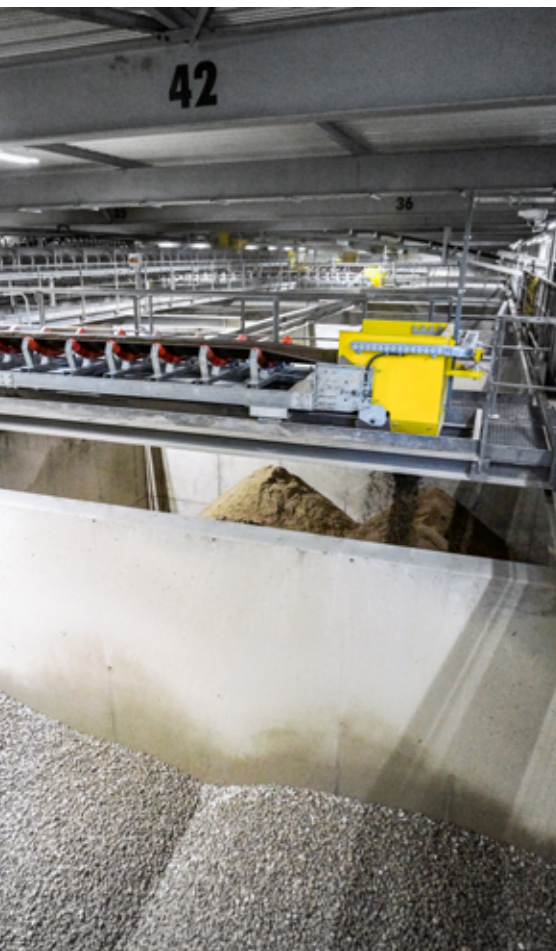
Genau definierte Rezepte: In 42 Boxen können die Eberhard-Unternehmungen in Rümlang Recycling-Kiesgemische einlagern (links) respektive für die Betonproduktion verwenden (rechts).
