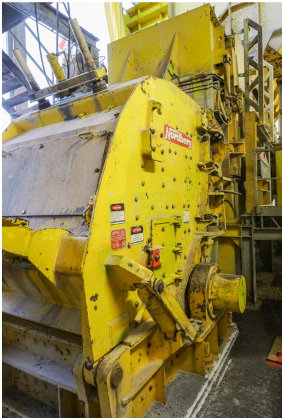
Unten: In einem Arbeitsgang zerkleinert dieser die Brocken mit einer Kantenlänge von bis zu 0,7 Metern in feines Granulat.
