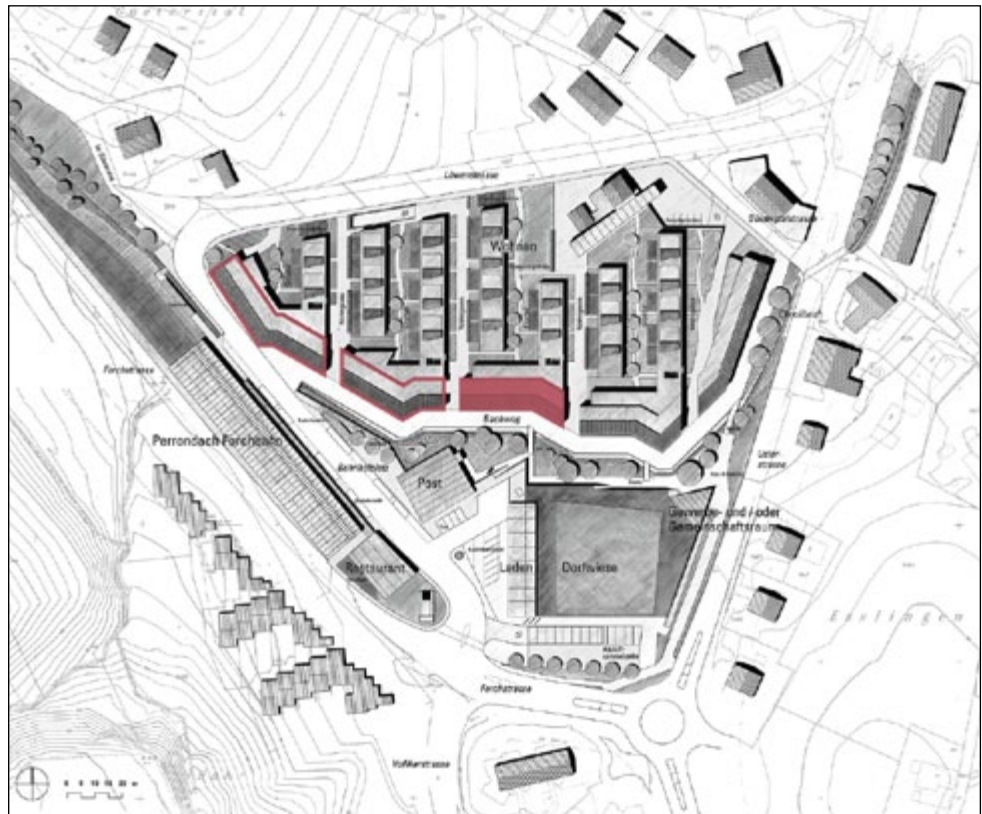
Abb. 1: Der Gestaltungsplan sieht eine Serie von fünf Geschäfts- und Bürogebäuden vor, die eine Wohnsiedlung umschliessen. Zwei Geschäftshäuser sind bereits erstellt (rot umrahmt), das dritte ist derzeit im Bau (rot). Allen gemeinsam ist der hohe Anspruch an umweltgerechtes Bauen. (Grafik: Basler & Hofmann nach dem Gestaltungsplan von agps Architekten)
