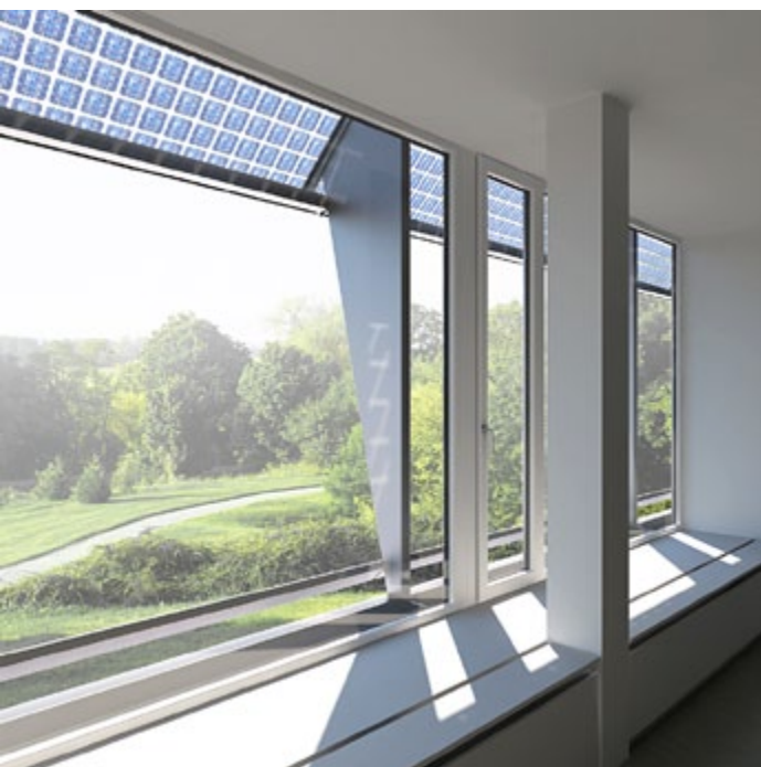
Abb. 6: Es gelangt viel Tageslicht in die Büroräume. Die Brüstungsklimageräte vor den Fenstern sorgen für ein angenehmes Innenraumklima. (Visualisierung Stücheli Architekten)
