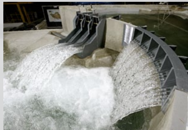
Modellversuch für die Talsperre Ostour im Iran.
