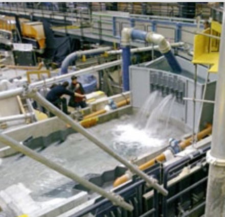
Modellversuch für die Talsperre Kariba auf dem Sambezi in Afrika.
