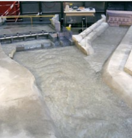
Projet pilote pour la nouvelle centrale au fil de l'eau de Hagneck sur le canal de Hagneck (le canal de Hagneck avant qu'il ne débouche dans le lac de Bienne).
